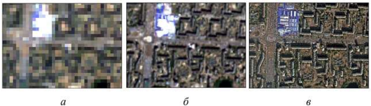
Рис. 3.3 Детальність зображення (просторова розрізненість) знімків на прикладі ділянки масиву Оболонь в м. Києві: 30 м – Landsat 8 (а), 10 м – Sentinel 2 (б), 1,24 м – WorldView 3 (в) [67]
