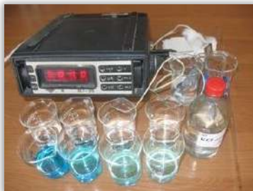
Рис. 5.1. Зовнішній вигляд зібраної схеми для вимірювання ЕРС елемента Даніеля-Якобі вольтметром В7-35.
